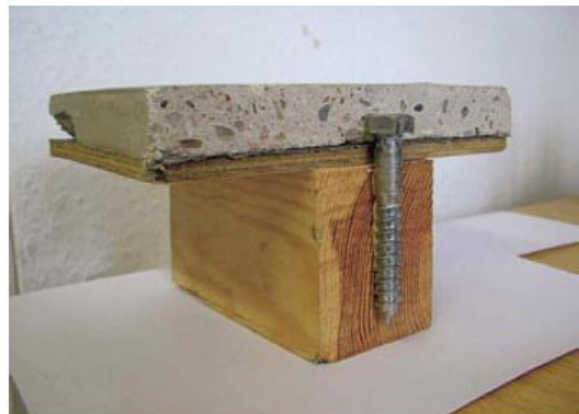
Obr. 2.53 Spriahnený drevobetónový strop [24]
